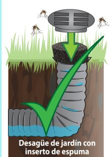
Los mosquitos NO PUEDEN ingresar al tubo después de agregar la malla de la ventana o el inserto de espuma debajo de la tapa de drenaje.
