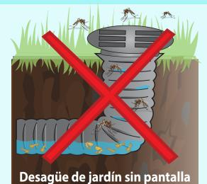
Los mosquitos pueden volar fácilmente DENTRO y FUERA de la tapa del desagüe del jardín.
